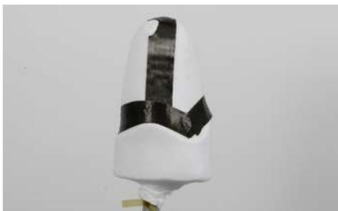
Polohujte následující vrstvy s mírným odsazením a upevněte oboustrannou lepicí pásku, aby nevznikly žádné hrany:
