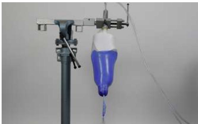
Vmasírujte laminační pryskyřici rovnoměrně do armování, přebytečnou pryskyřici ponechte na distálním konci a podvažte.
