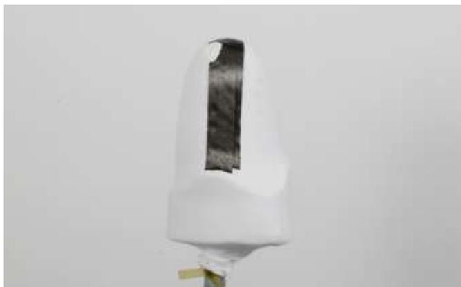
Následující vrstvy pokládejte mírně s odsazením a upevněte oboustrannou lepicí pásku, aby nevznikly žádné hrany.
