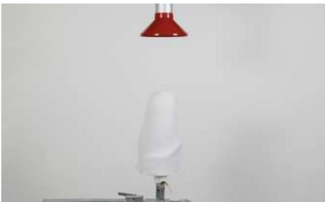
Svažte jednu změkčenou PVA fóliovou hadici na úzkém konci a natáhněte ji na sádrový model. Podvažte fólii mezi prvním a druhým otvorem odsávací trubky a zapněte vývěvu. Zapošijte distálně první armovací vrstvy, aby se konec pahýlu přesně vytvaroval:
