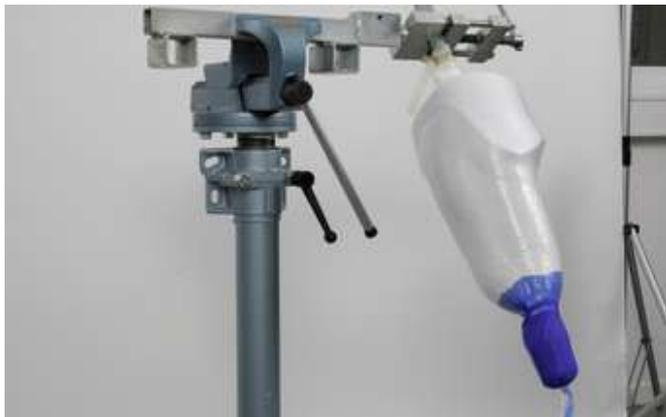
Přetáhněte 2 vrstvy perlonové trikotýnové hadice. Nalijte laminační pryskyřici do odměrného kelímku. Volitelně: Přidejte pigment (3% celkové hmotnosti laminační pryskyřice) a rozmíchejte.
