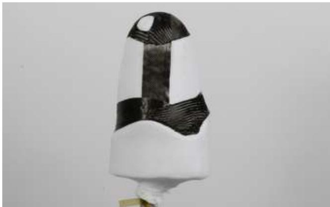
Následující vrstvy polohujte s mírným odsazením a upevněte je pomocí oboustranné lepicí pásky, aby nevznikly žádné hrany:
