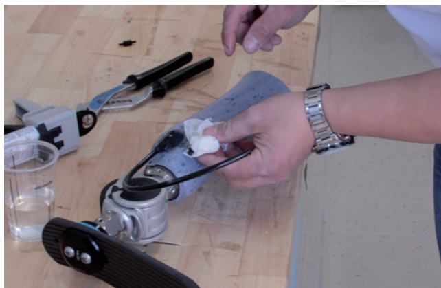
4 Hadříkem namočeným v ředidle odstraňte přebytek lepidla a nechte ztvrdnout (v případě 636K49 SuperGlue cca 5 minut).
