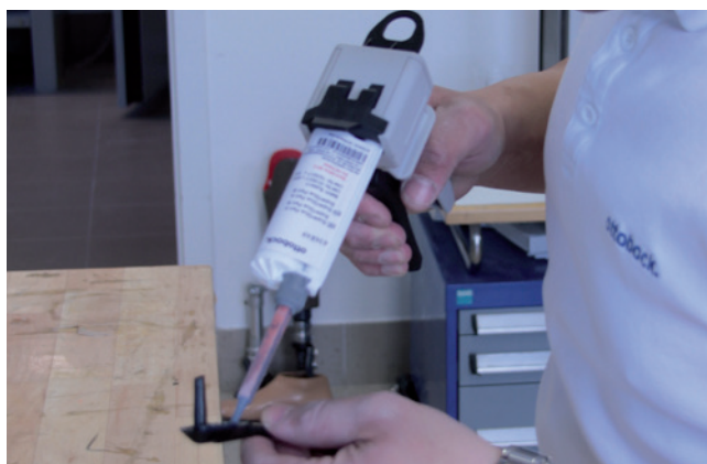
2 Na lůžkový konektor naneste lepidlo. Doporučujeme 636K49 SuperGlue, které nestéká a výborně dotěsní přechod mezi konektorem a lůžkem.
